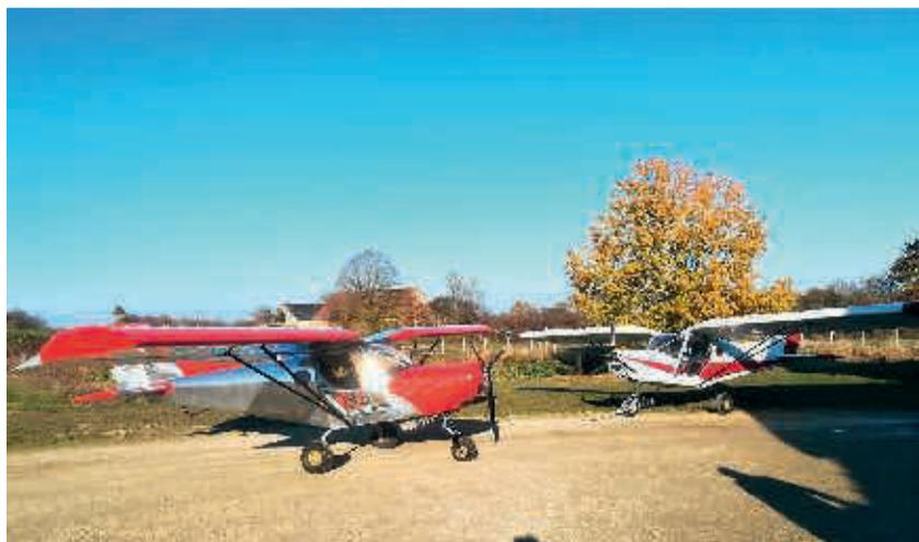
ULM Biplane type G1 avec moteur 100 cv. Vitesse de croisière 170 km/h, décollage en moins de 100 mètres et atterrissage inférieur à 80 m
